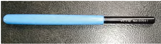
Verktyget för att slå av gänginsatsens tapp.
