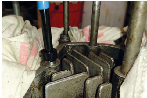
Gänginsatsen på väg ner i den friska gängan. Insatsen drogs ned ca 1 1/2 gänga under packningsytan.
