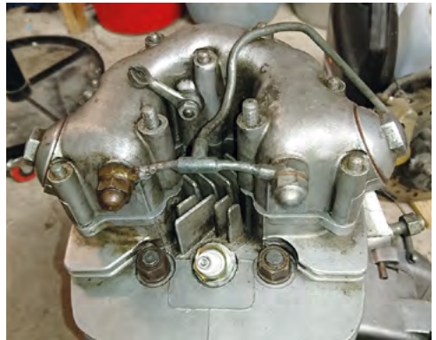
Och här är vipparmshuset på plats med alla pinnbultar på plats.
