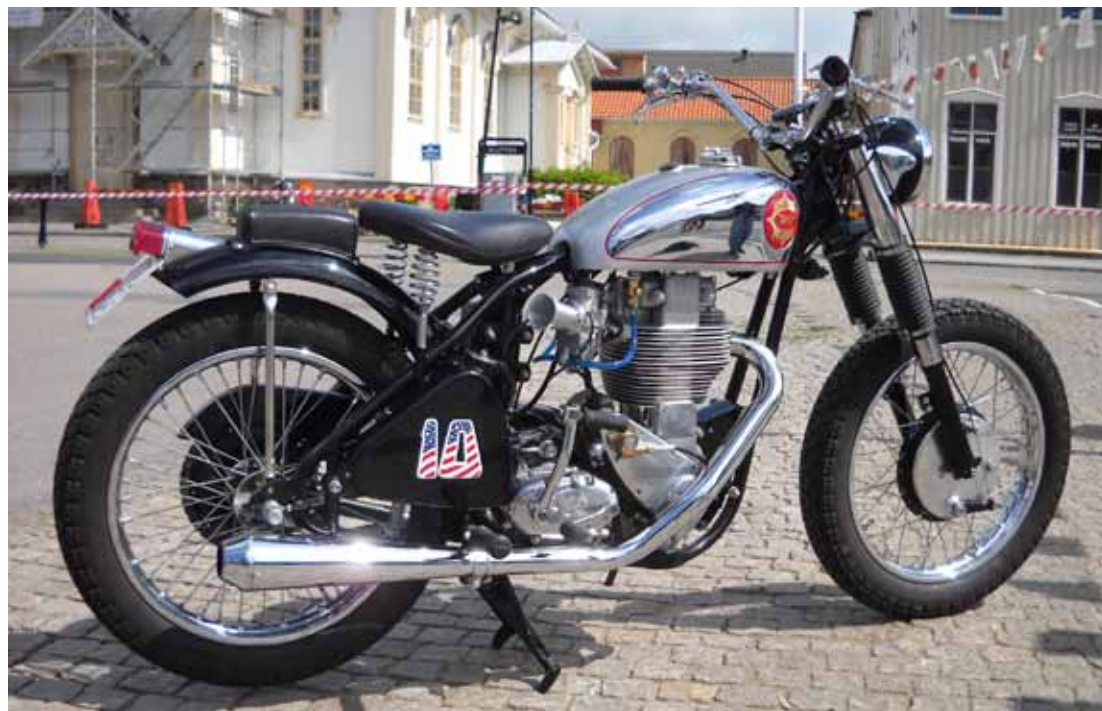
Modifierad från Dirt Track-banan med sladd till att kunna gå på vägen. Både bromsar och ljus krävs ju här, Morgan Johanssons BSA Gold Star BB32R Dirt Track 1957.
