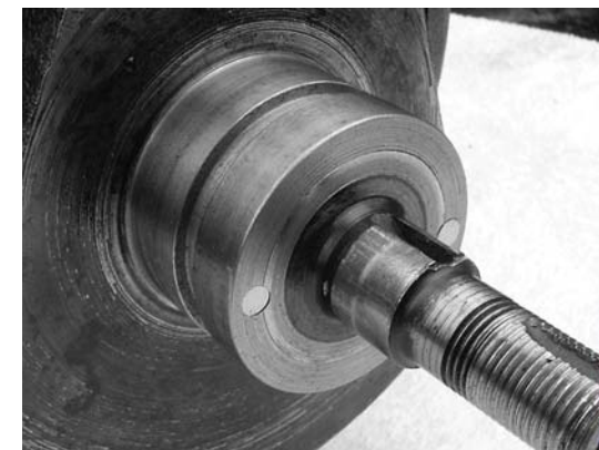
Bilden visar hylsan fixerad mot vevaxeln med två stift. Foto: Torsten Ahlin.
