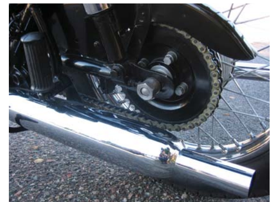
O-ringskedja har ökat driftsäkerheten. Foto: Lasse Camenius.
