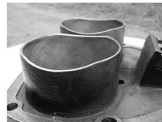
Bilden visar hur man måste justera skörtarna för att få säker frigång mot vevaxeln. Foto: Torsten Ahlin.
