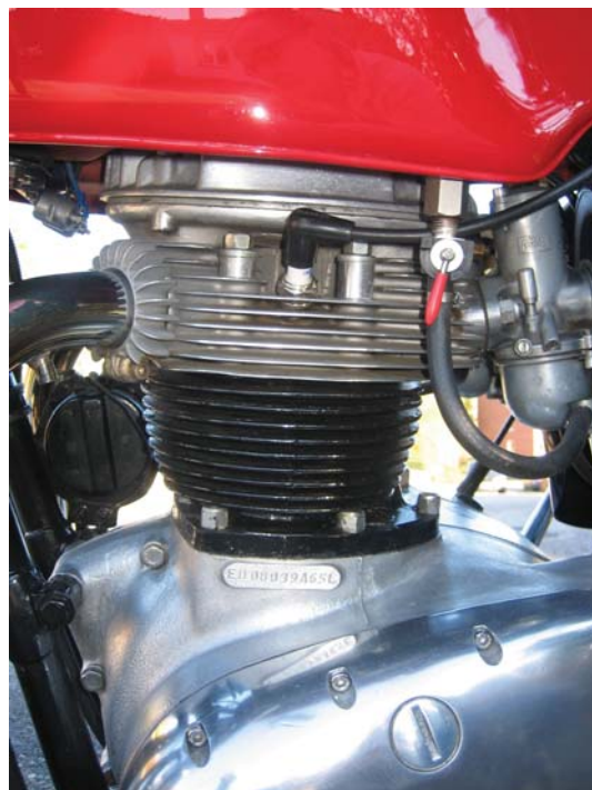
De förlängda yttre pinnbultarna som hjälper till att ge en tätare motor. Foto: Lasse Camenius.
