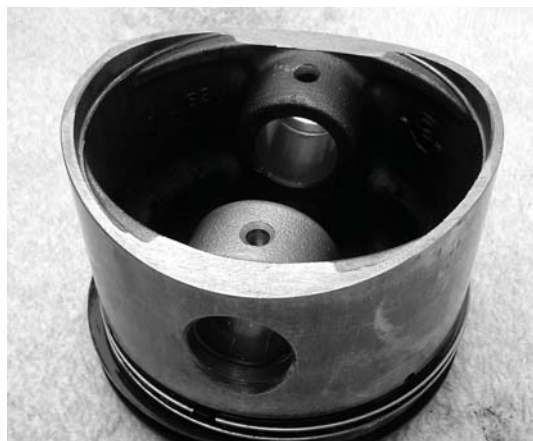
Även kolvarna måste justeras för att få en säker frigång från vevaxeln. Foto: Torsten Ahlin.
