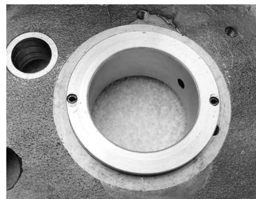
Här syns hur bussningen fixerats mot vevhussidan med två stift. Foto: Torsten Ahlin.
