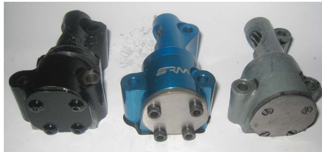
De testade oljepumparna, från vänster, MCA, SRM och BSA Original zink/aluminium. SRM-pumpen vann överlägset testet med sin höga kvalitet. MCA-pumpen rekommenderas ej, satsa då hellre på en renoverad BSA-pump från BAS Motor.
