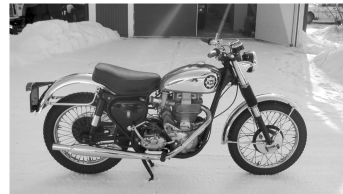
Tillbakadraget avgasrör halvhögt styre kort sadel på den landsvägskonverterade Catalinan.
